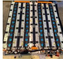
Fig 3: Battery Pack para BESS de 5.015 kWh.
