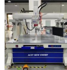
Fig 5: Equipo de soldadura laser para línea BESS.
